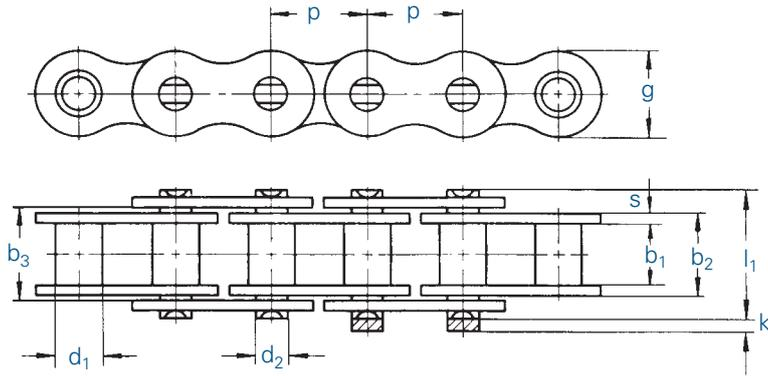
Kettengeschwindigkeit bei Buchsenketten: bis 20 mm Teilung ... bis 5 m/s
