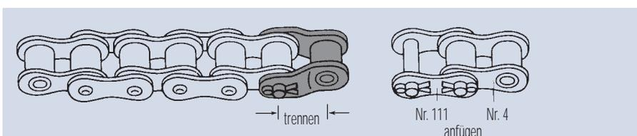
Achtung: Bei Einbau von gekröpften Gliedern darf nur mit 80% der Bruchlast gerechnet werden.
