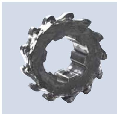
die Schmutzablagerungen im Grund der Zahn-lücken entfernt werden, weil dadurch die Kette gedehnt wird. Anschließend ist die Verzahnung daraufhin zu untersuchen, ob die Zähne nicht zu weit abgenutzt sind. Bei starkem Verschleiß oder hakenförmigen Zähnen werden die Räder besser durch neue ersetzt.
