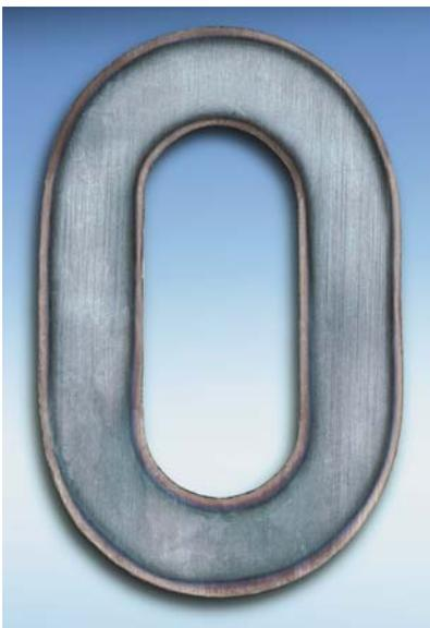
Abbildung 3: Längsschnitt durch ein einsatzgehärtetes Kettenglied.
