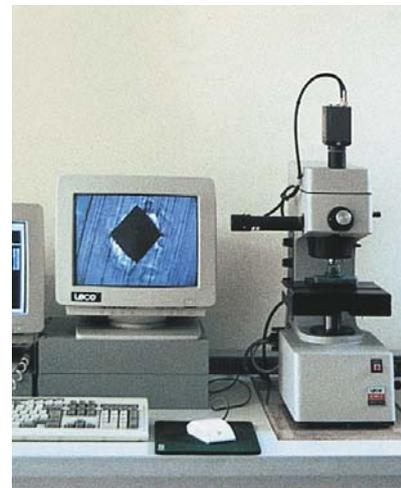
Abbildung 9: Härteprüfautomat (Archivierung der Härteprüfwerte inklusive der Härteverlaufskurven)
