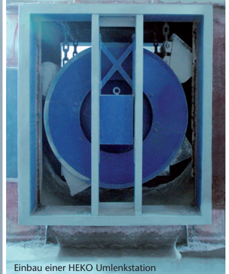
HEKO Umlenkeinheit mit wartungsfreien Lagern
