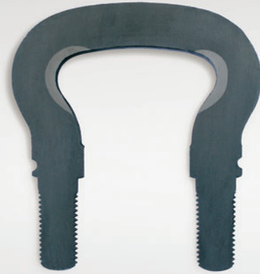
Längsschnitt durch einen im Gelenk induktiv gehärteten Kettenbügel
