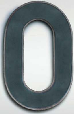
Längsschnitt durch ein einsatzgehärtetes Kettenglied
