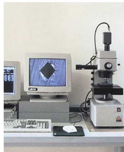
Abbildung 9: Härteprüfautomat (Archivierung der Härtewerte inklusive der Härteverlaufskurven)
