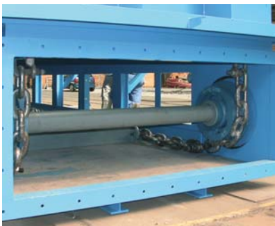
Abbildung 65: Antrieb, Spanneinheit und Umlenkung einer Nassentschungsanlage mit HEKO Bauteilen
