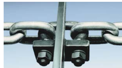
Abbildung 12: Mitnehmerbefestigung durch HEKO Kettenbügel Typ DIN 5699
